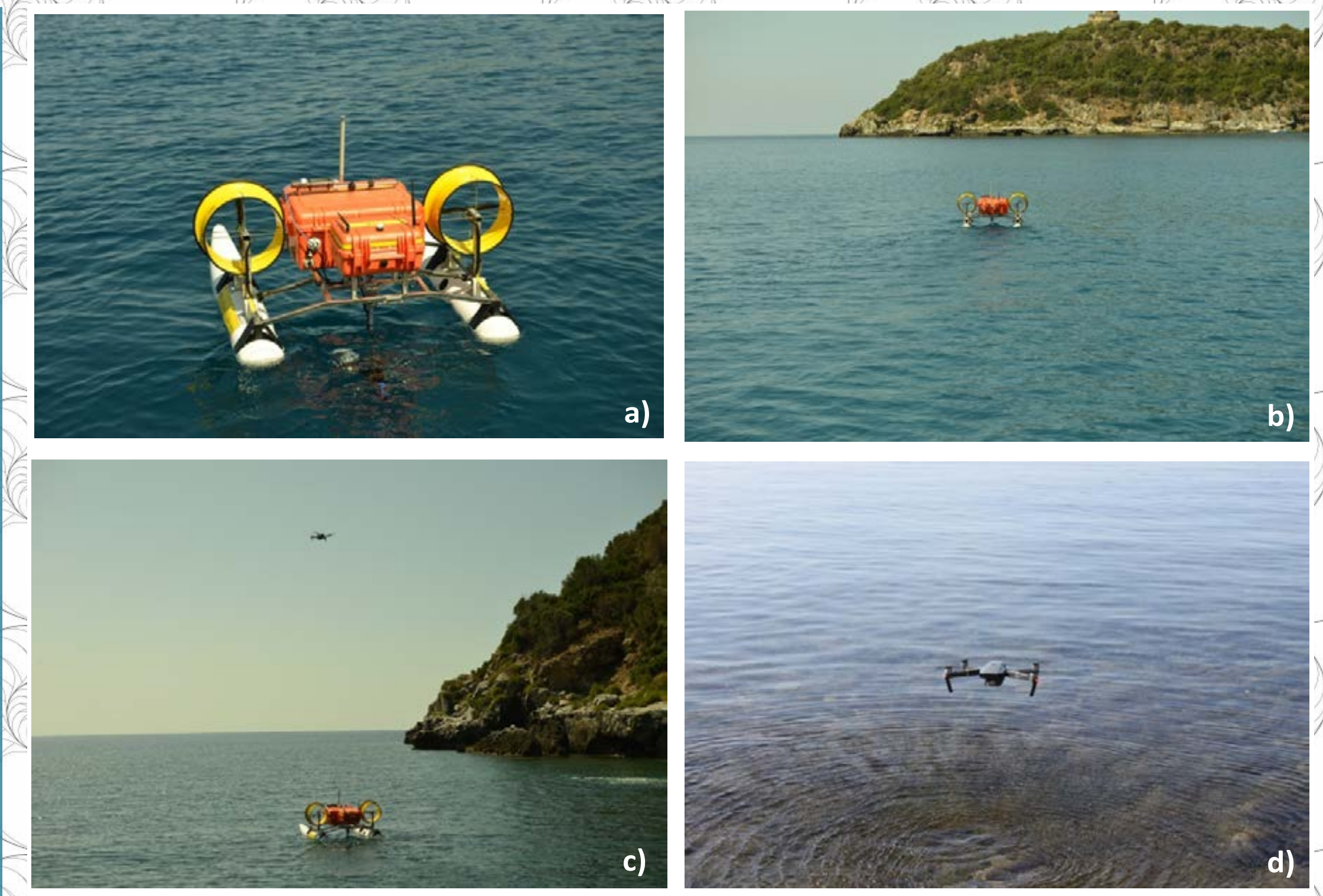
Figura 2: Veicolo autonomo di superficie (ASVs) DEVSS (a,b,c), Sistema aeromobile a pilotaggio remoto (SAPR) DJI Mavic Pro (d).
